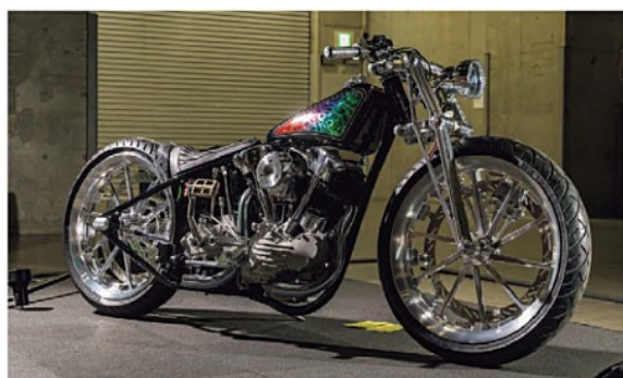
「ケンズファクトリー」のシングルクレドルフレームのナックル。ガーターフォークやホイールなど、自社パーツで組んだオリジナリティあふれる一台
