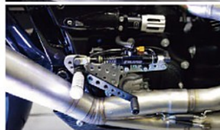
「ジョイライドスピードショップ」が手がけたローライダーSTのパフォーマンスカスタム。バンク角を稼ぐため車高アップや、バックステップ化するなど、レース走行を想定した仕様
