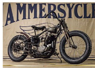
「ハマーサイクル」のダートマシンはナックルを単気筒化し、走行に関わるパーツを残して限界まで軽量化した本気のヴィンテージレーサー
