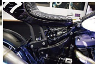
「ジョイライドスピードショップ」が手がけたローライダーSTのパフォーマンスカスタム。バンク角を稼ぐため車高アップや、バックステップ化するなど、レース走行を想定した仕様
